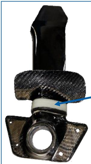
Une protection thermique limitant l'échauffement de la zone du fuseau au droit des disques de freinage (ceux-ci peuvent monter à plusieurs centaines de degrés).
