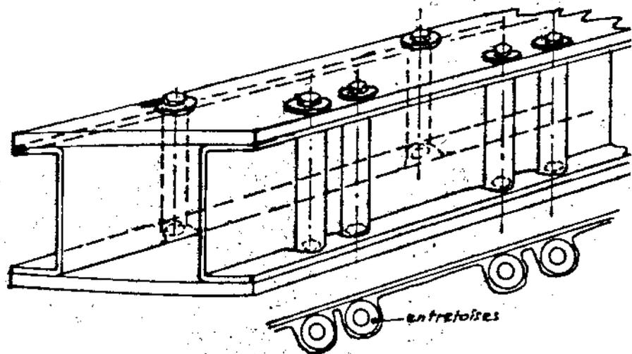
Certains cas de corrosion par l'intérieur de ces entretoises nous ayant été signalés, nous recommandons de les inspecter lors de la prochaine Grande Visite de l'appareil au plus tard. Pour cela, retirer les vis qui les traversent et qui fixent les supports d'articulation.
