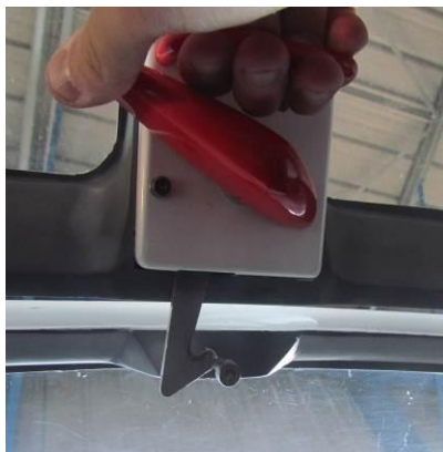
Verrière entre-ouverte, poignée de verrouillage en position ouverte.
