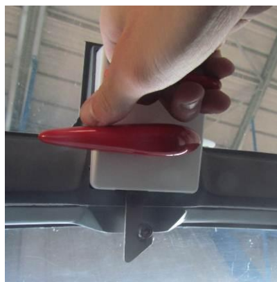
Verrière plaquée contre le pare-brise, passage du crochet derrière le téton
