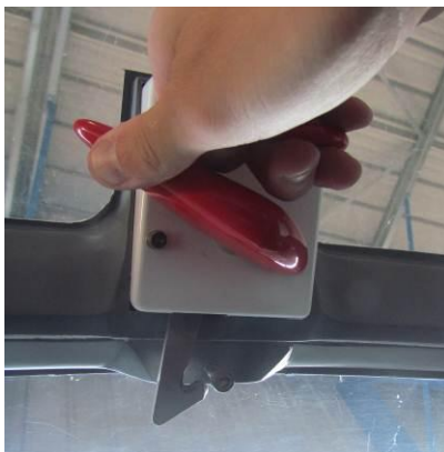
Verrière plaquée contre le pare-brise, poignée de verrouillage en position ouverte
